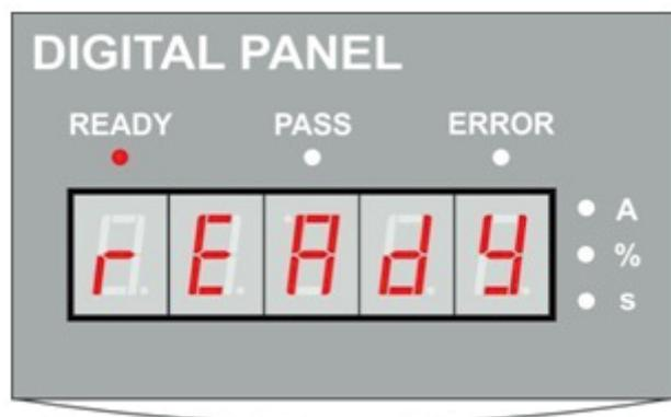
Рис. 12: Привод готов к работе
