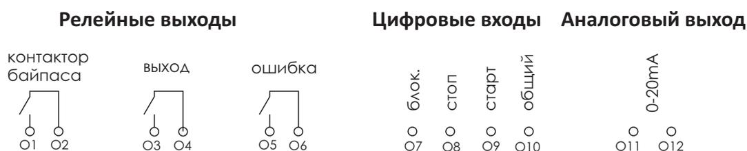
Рис. 7: Функции клеммных зажимов цепей управления
